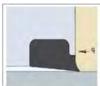
Abbildung 9 Hygienegerecht konstruierter Lippendichtring
